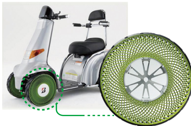
エアフリーコンセプト装着の高齢者・身障者向け電動カート
