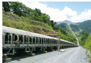
山岳地帯を越えて鉱石を運ぶコンベヤベルト (インドネシア)
