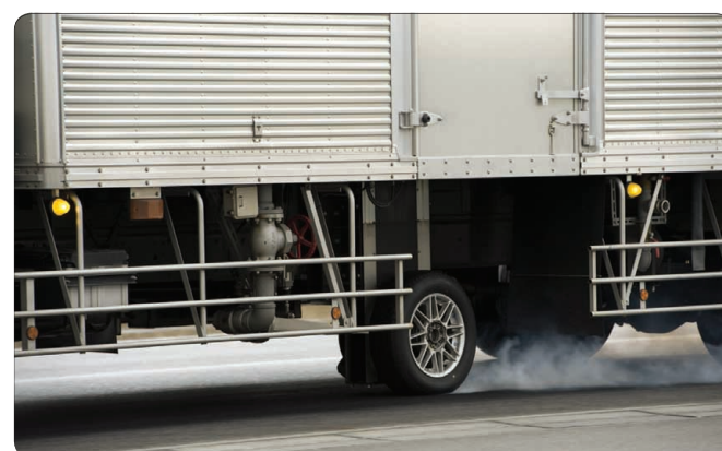
トラックに特別にタイヤを取りつけ、走行中路面に接触させることで、タイヤの摩擦などを測定
