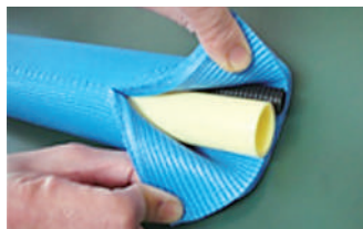
保温材の引裂き
