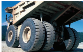
露天掘り鉱山で活躍する 超大型建設・鉱山車両用タイヤ
