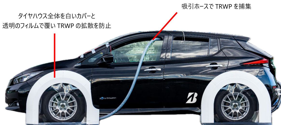
TRWP を捕集する装置を自動運転車に装着した様子
