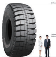
世界最大級のタイヤ (外径約4m)
