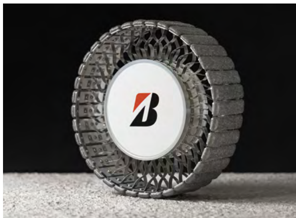
「エアフリー」技術が応用された月面探査車用タイヤのコンセプトモデル
