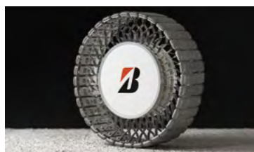
「AirFree」の技術が応用された月面探査車用タイヤのコンセプトモデル
