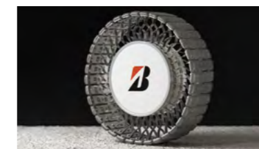
「AirFree」の技術が応用された月面探査車用タイヤのコンセプトモデル
