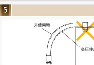
ホースに内圧が加わっているときはホース長さに若干の変化が生じます。しかしこの変化を抑えようとしてホースの曲がり部分を固定しないでください。(配管の見直しが困難な場合は固定せずにスプリング、外装ワイヤブレードにてホースを保護してください。)
