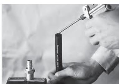
ホースをナイフ等で必要な長さに軸方向と直角に裁断して下さい。ホース内面と口金具のインサート部分に、水、又は石けん水をつけて下さい。
