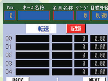
締付規格登録画面 (任意の締付規格を50件登録できます)
