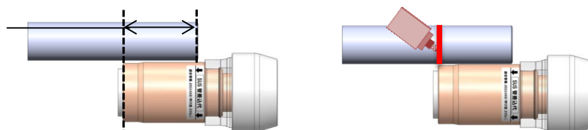
(1) 差込代シール中央線を目安に SUS 管を合わせる
