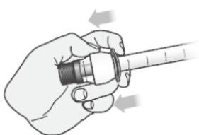
**⑤** 取外しリングは継手方向に押し込んだままパイプを継手反対方向にまっすぐ引き抜いてください。
