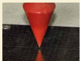
下げる振りは、設置されている免震ゴムに水平方向のズレが生じていないか確認する装置です。
